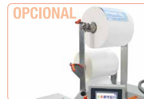
Sistema de carga de film doble ultra-rápido: Módulo de carga de film con dos ejes expansibles concebido para disponer de dos bobinas en laminadora listas en todo momento.
